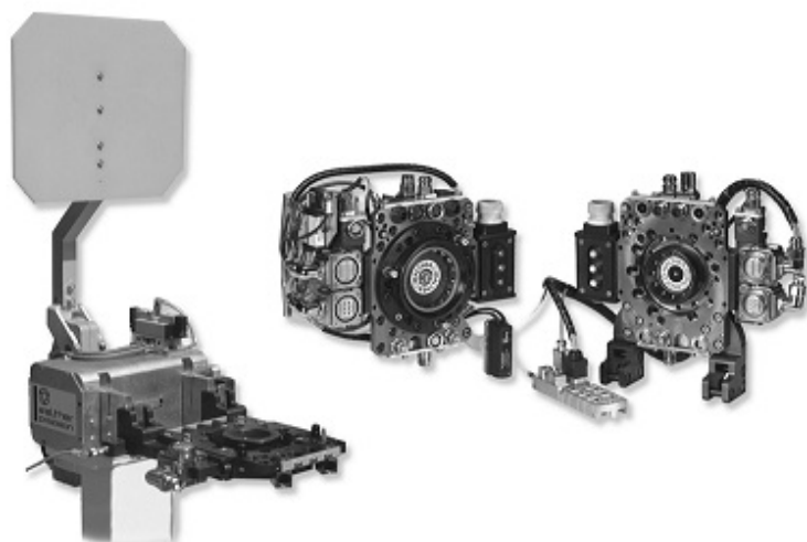
WALTHER TOOL MASTER Система замены и хранения инструмента робота
